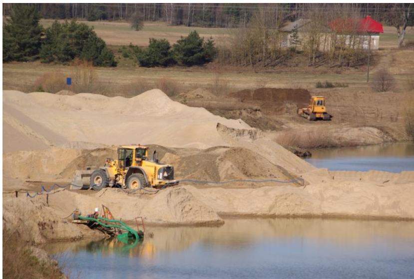
Fot. 17 Przykładowe uformowanie brzegu w trakcie eksploatacji złoża zawodnionego (teren złoża Gostomie)
